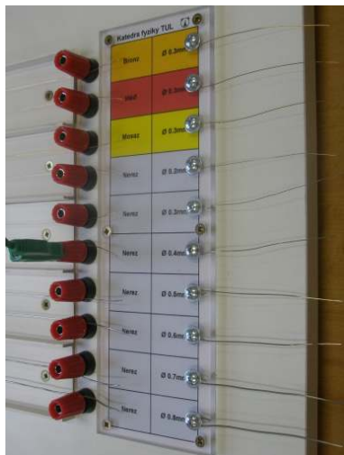
Obr. 3 Detail kousků drátů pro měření jejich průměrů
