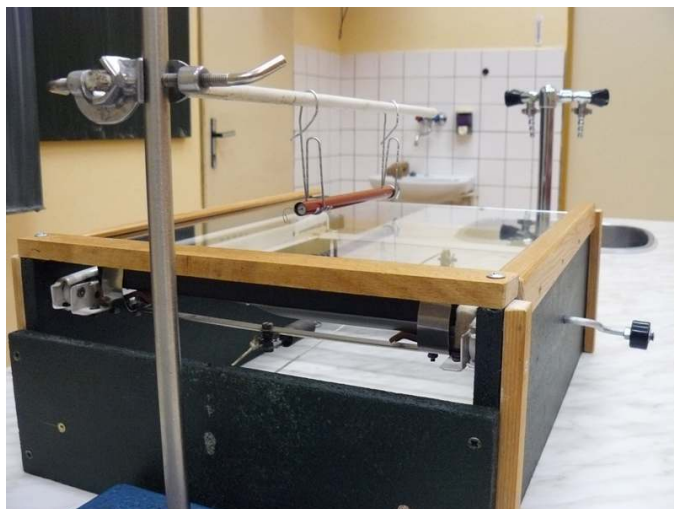
Obr. 3 Kmity kyvadla – uspořádání experimentu
