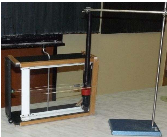
Obr. 5 Kmity pružinového oscilátoru – vertikální poloha skeneru
