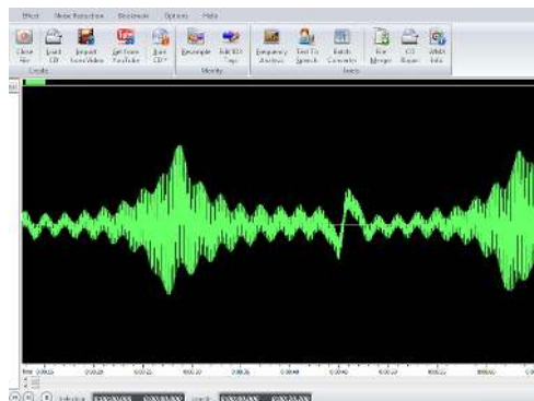
Obr. 3 Záznam signálu s patrnou modulací zvukovými rázy
