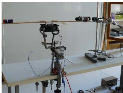
Obr. 2 Měření rychlosti zvuku z Dopplerova jevu – uspořádání experimentu
