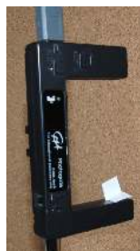
Obr. 2 a 3 Meranie rýchlosti guľôčky pomocou optických brán
