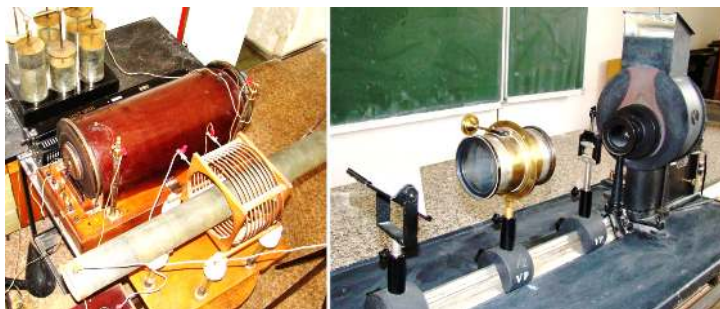
Obr. 8 Sto let staré pomůcky se na MFF stále používají – Teslův transformátor a optická lavice. Snímek z roku 2008 (foto B. Vybíral)
