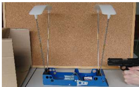
Obr. 1 Meranie rýchlosti guľôčky pomocou chronometra
