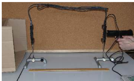
Obr. 2 a 3 Meranie rýchlosti guľôčky pomocou optických brán
