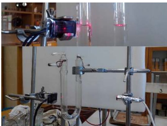
Obr. 6 Kmity vodního sloupce v U-trubici s detailem rovnovážné polohy
