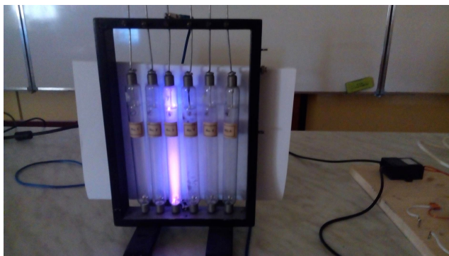
Obr. 7 Výboje za sníženého tlaku se zdrojem AC 15 kV
