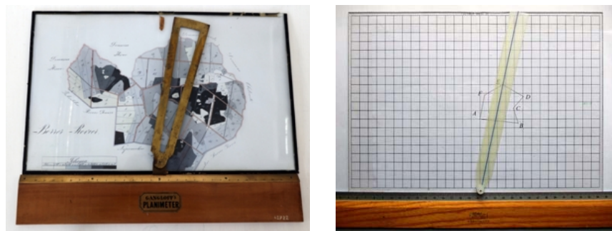
Obr. 9 Gangloffův planimetr, originál a model
