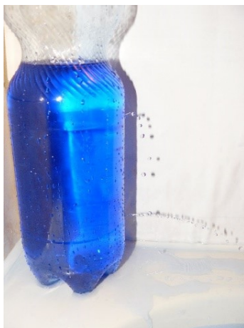
Obr. 5 Kvalitativní pokus k Torricelliho zákonu
