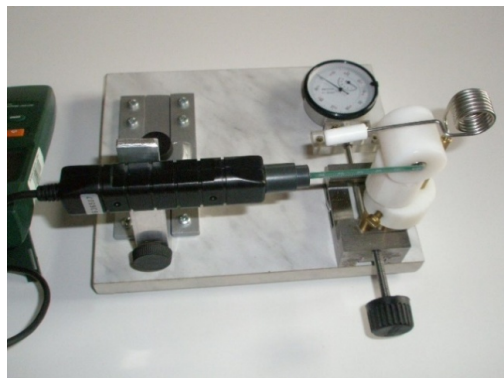
Obr. 3 Zařízení pro upevnění magnetky, připevnění raménka Hallovy sondy, posuv vzorku nastavovacím šroubem, úchylkoměr pro měření vzdáleností a vzorky magnetek v plastových ochranných obalech
