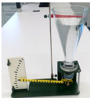
Obr. 1 Hartlův přístroj k ověření hydrostatického paradoxu
