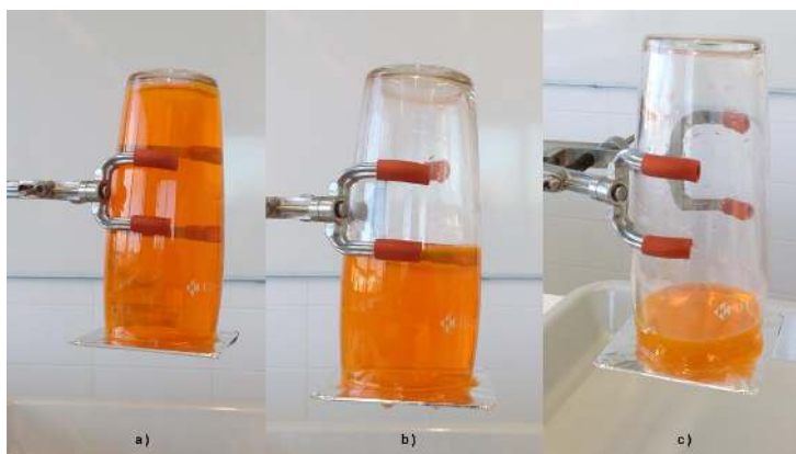
Obr. 1 Zcela plná, poloplná a téměř prázdná nádoba při demonstraci tlaku vzduchu
