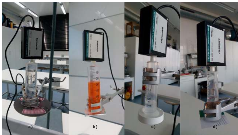
Obr. 2 Různé typy destiček: a) impregnovaný tuhý papír, b) tuhý papír obalený hliníkovou fólií, c) plastové víčko d) list papíru
