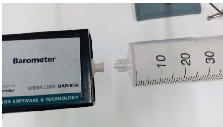
Obr. 6 Připojení injekční stříkačky k tlakoměru Vernier
