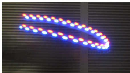
Obr. 3 Demontrace, že ve střídavém napětí se polarita opravdu střídá
