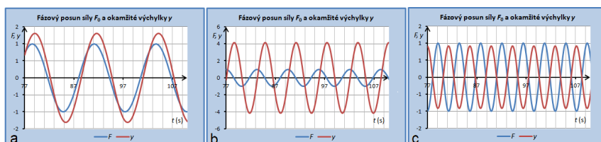
Obr. 5 Časové diagramy nuceného kmitání při: a) \omega < \omega_0 ; b) \omega = \omega_0 ; c) \omega > \omega_0
