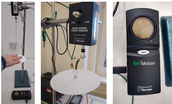
Obr. 3 Měření deformace pružiny při jejím natahování a měřicí senzory Vernier (síla, vzdálenost), uprostřed pružina s připojenými vodiči sloužícími k ohřátí pružiny průchodem proudu pro měření v austenitické fázi
