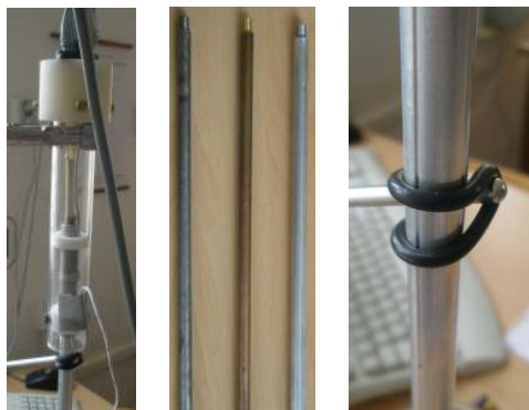
Obr. 3 a) Topné těleso umístěné v plexisklové trubce s termočlánkem pro měření jeho teploty při kompenzaci ztrát. b) Kovové tyče (zleva ocel, mosaz a dural). c) detail upevnění teplotního čidla na tyči pomocí gumového O-kroužku.
