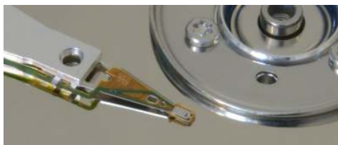
Obr. 3: Pohľad záznamovú a čítaciu hlavu hard diskovej jednotky
