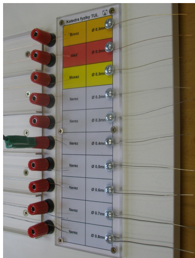
Obr. 3 Detail kousků drátů pro měření jejich průměrů
