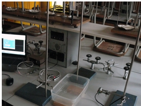
Obr. 10 Experimentální uspořádání metody největší kapky
