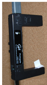
Obr. 2 a 3 Meranie rýchlosti guľôčky pomocou optických brán
