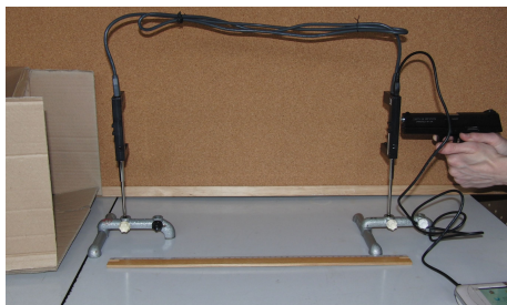
Obr. 2 a 3 Meranie rýchlosti guľôčky pomocou optických brán
