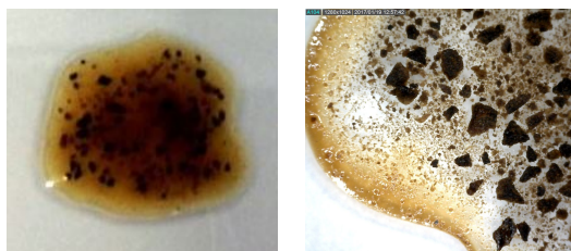
Obr. 4 Kapka kávy s rozptýlenými částicemi, rozptýlené částice se tlačí do středu kapky, na okraji žádné nejsou (vpravo)
