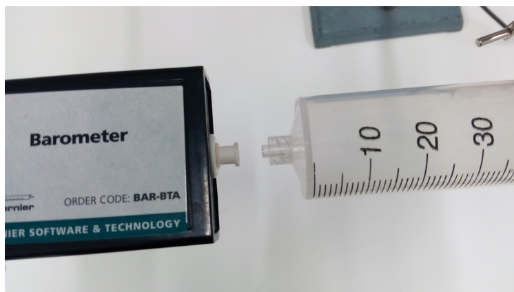
Obr. 6 Připojení injekční stříkačky k tlakoměru Vernier
