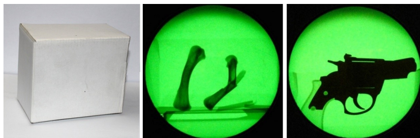
Obr. 5 Vlevo: prozařovaná krabička s ukrytými předměty; uprostřed: celá a zlomená kuřecí kost v papírové krabičce; vpravo: model revolveru v papírové krabičce
