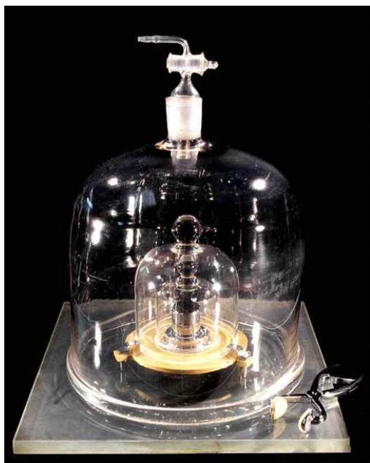
Obr. 3 Mezinárodní prototyp kilogramu (zdroj: BIPM)
