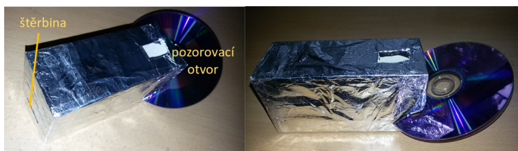
Obr. 7 Spektroskop z CD a krabičky od čaje
