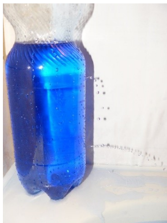
Obr. 5 Kvalitativní pokus k Torricelliho zákonu
