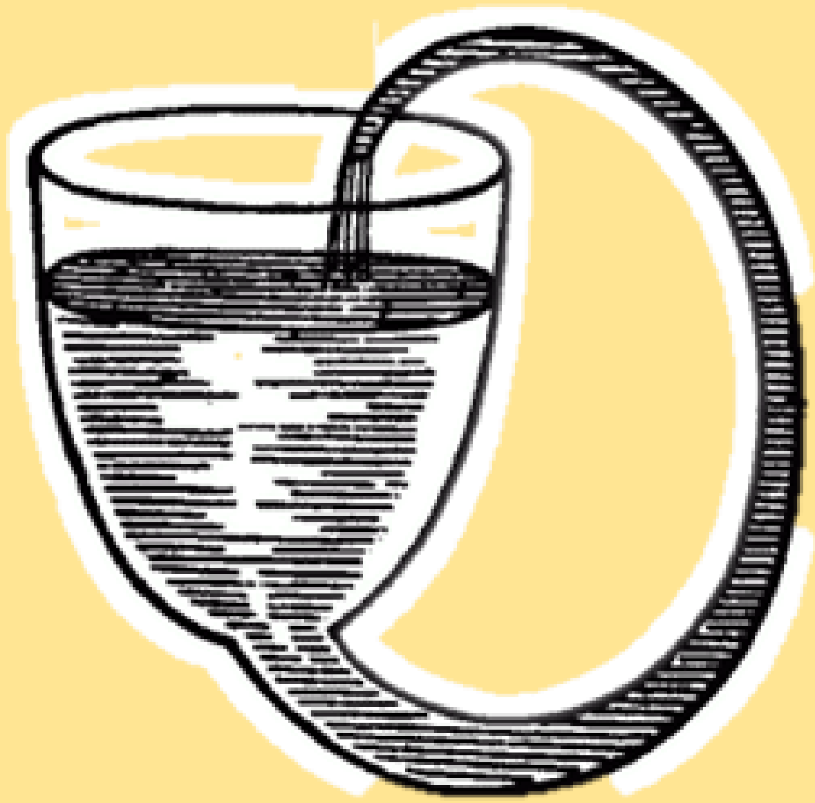
Obr. 2: Boylova samoplňící se číše (perpetuum mobile) [71]
