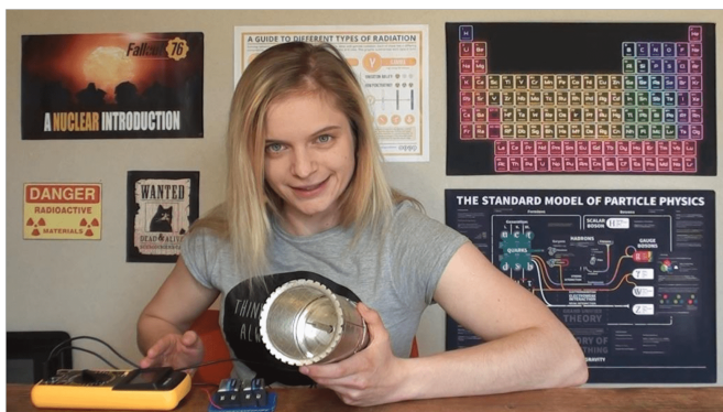
Obr. 5 Pokusy s vlastnoručně vyrobenou ionizační komorou podle návodu z [5] v domácím studiu
