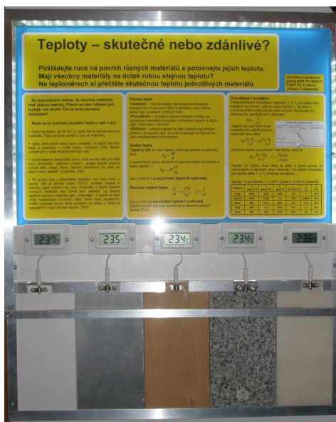
Obr. 4 Interaktivní nástěnka demonstraci dotykové teploty na různých druzích materiálů – dole zleva panely materiálů: plast (Trovitex), kov (hliník), dřevo, žula, plast (Silon).
