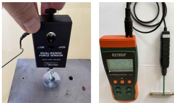
Obr. 4 Sestava na měření přídržné síly magnetické fólie ke kovové desce a určení magnetické indukce přípravků na magnetizaci fólií do Halbachova pole
