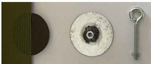
Obr. 2 Vzorky magnetické fólie připevněné na podložku a závitové oko, vlevo jsou magnetické domény vzorku na podložce zviditelněny detektorem
